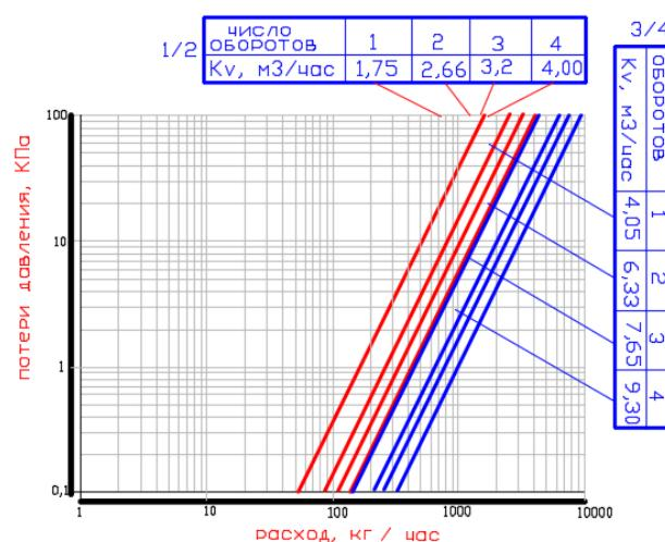
\*Графики приведены при подаче теплоносителя под золотник. При обратной подаче теплоносителя к  $K_v$  применяется коэффициент 0,88.
