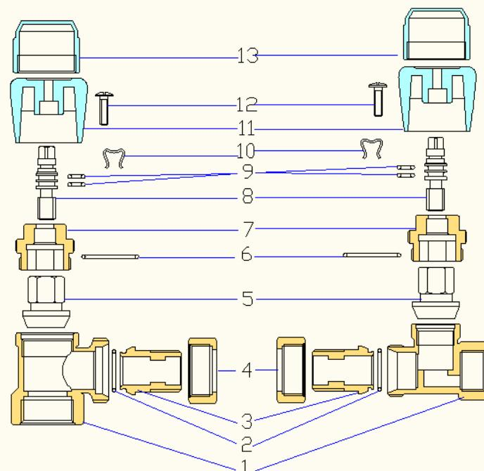
Корпус клапана 1 изготовлен из латуни CW617N методом горячей штамповки. К корпусу через уплотнительные прокладки из EPDM 2 и 6 присоединена латунная муфта вентильного узла 7 и патрубок полусгона 3. Патрубок полусгона крепится к корпусу с помощью накидной гайки 4.
